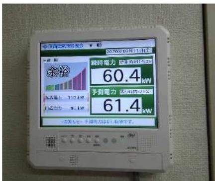
左図は、本社棟に設置している「デマンド監視モニター」です。このモニターを介して、現在のデマンド(30分間毎の電力消費量(Kw))を常時監視が出来る仕組みです。
